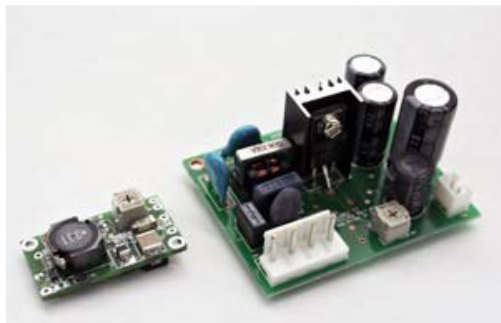
光洋電子工業が開発したLED照明用の電源回路(左)と従来品
